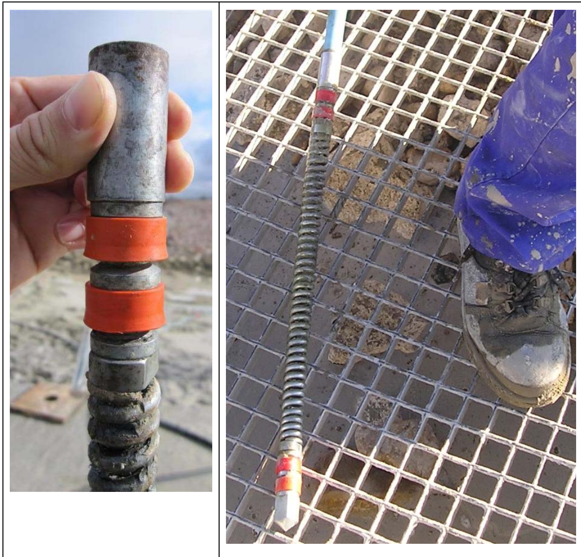
Figura 23: Ejemplo de obturador doble de membrana para inyección IRS por el interior de tuberías de poco diámetro (U&A).
