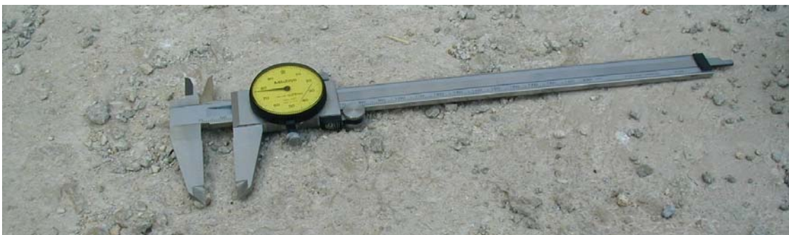
Figura 42: Calibre con micrómetro para lectura de centésimas de milímetro (U&A).
