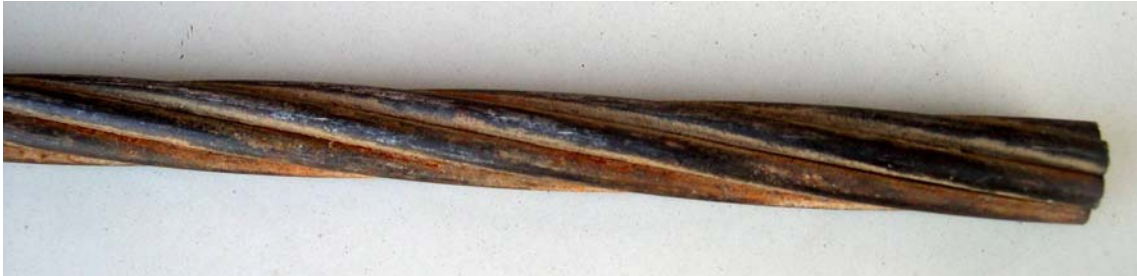
Figura 10: Detalles de un cable de anclaje convencional de 7 alambres trenzados.
